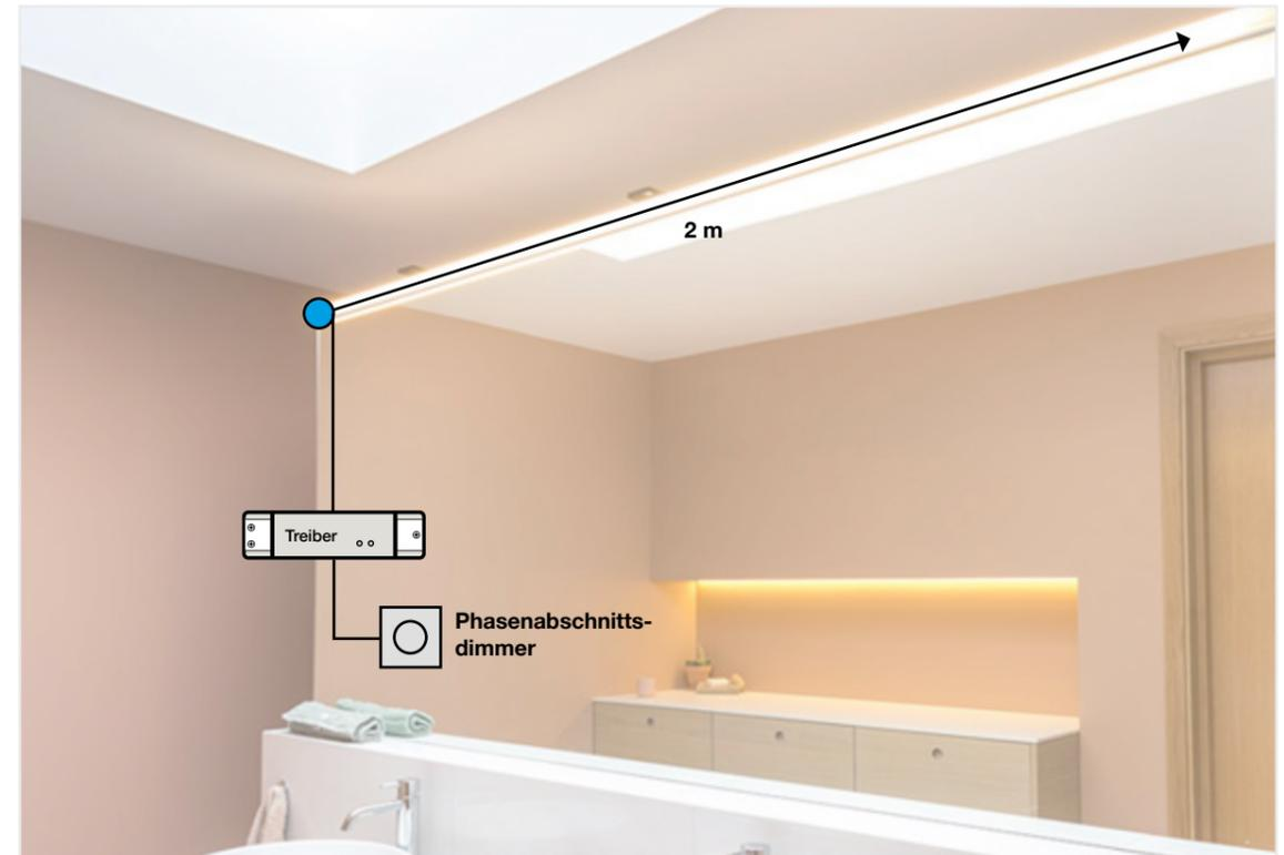
**1** Profil → **2** LED-Strip → **3** Betrieb & Steuerung
